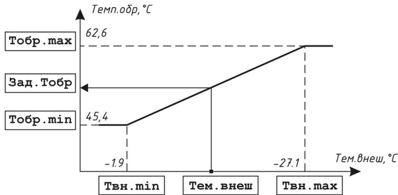
Рисунок 9.2.1 – Температурный график теплоснабжения
